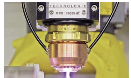
Oberflächen können mit einer neuartigen Plasmaschicht gegen Keime «immun» gemacht werden. (Foto: Inocon)
