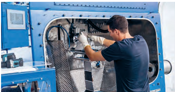
Anlage für das Recycling von Lithiumeisenphosphat-Batterien. (Foto: Kyburz Switzerland AG)
